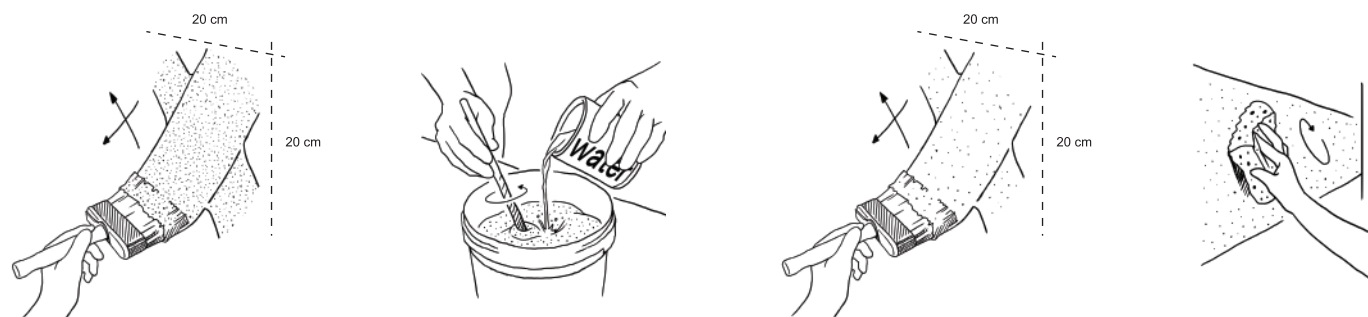
以石灰刷(交叉塗抹)塗上第一道 石灰水 Lime paint
